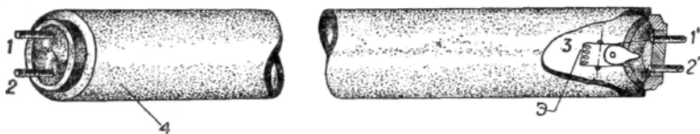
Люминесцентная лампа с каляющимися электродами: 1, 2 и V, 2' — ножки-вводы электродов.
